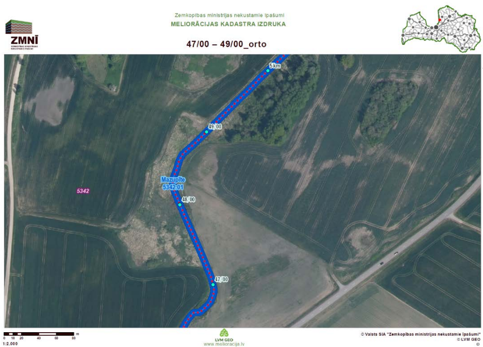
1.attēls. Sedimentācijas baseina ierīkošanai piemērots valsts nozīmes ūdensnotekas Mazupīte posms (pik. 47/00 – 49/00) – fonā ortofoto karte.
